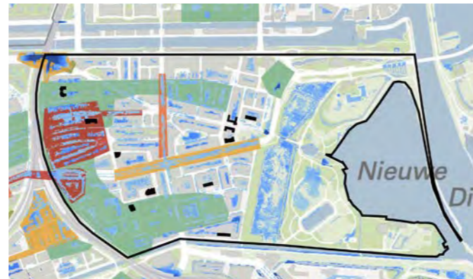
Wateroverlastkaart Een regenwaterknelpunt is (een deel van) een straat of buurt met een (sterk) verhoogde kans op overlast en schade bij extreme neerslag. Groen is hoog grondwater, geel is urgent, rood is extreem urgent. Bron: Klimaatatlas Metropoolregio Amsterdam (2020).
