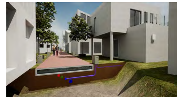
Leidingwerk in Living LAB 040 Leidingen in het grid liggen onder de weg, met naast de weg aansluitingsmogelijkheden voor woningen.
