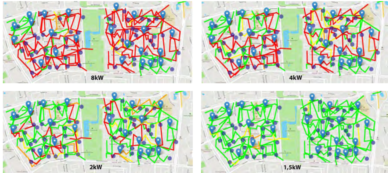
Consequenties energie strategieën Bovenstaand voorbeeld (Woensel-Noord, een wijk in Eindhoven) laat de consequenties zien van verschillende energie strategieën. Benodigde netverzwaring (rode lijnen) bij 8kW, 4kW, 2kW en 1,5kW (huidig net) strategie. (bron: Enexis)
